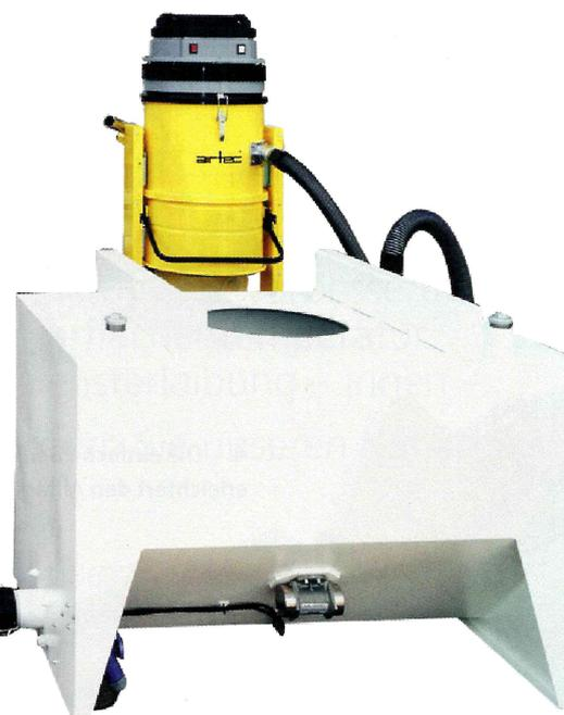
bilität. Das Gerät ist sowohl für Eimer- wie für Sackware geeignet und verfügt über einen Außenrüttler. Durch die Gesamtkonstruktion mit klappbarem Motor, kann die Maschine wesentlich leichter gereinigt werden.
